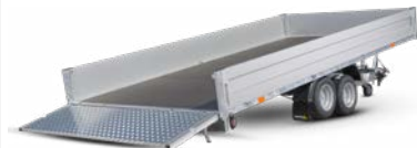
Adam v provedení s bočnicemi a hydraulicky sklopným rá- mem pro usnadnění najíždění
