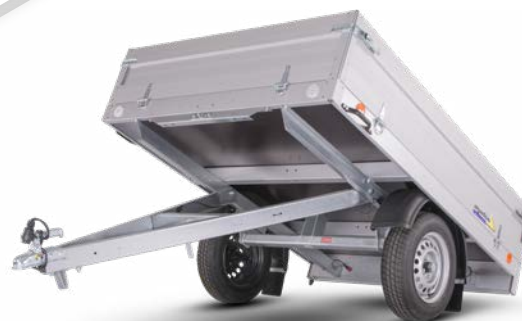
Titus se sklopenými odnímatelnými bočnicemi
