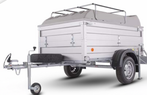
VZ s hliníkovými bočnicemi, nástavbou bočnic a uzamykatelným laminátovým víkem
