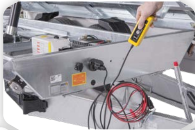
Hydraulické třístranné sklápění korby
