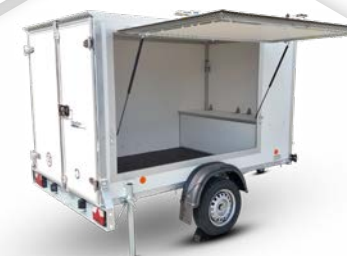
Boční klapka s plynovými vzpěrami
