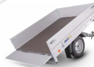
Titus ve sklopené poloze se zadním otevíracím čelem
