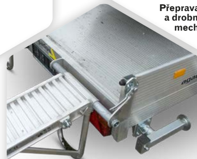
Nájezdy s podpěrou, posuvné dle rozchodu kol pře- pravovaného stroje
