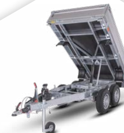
Delta v provedení valník – jednostranné sklápění korby
