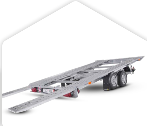
Sklopná korba s nájezdy pro snadnější nájždění auta
