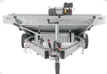
Posuvný naviják po celé šířce pří- věsu
