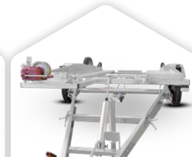
Panter ve standardním provedení včetně navijáku o nosnosti 900 kg
