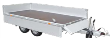
VZ-33 s předním otevíracím čelem, odnímatelnými sloupky a bočnicemi
