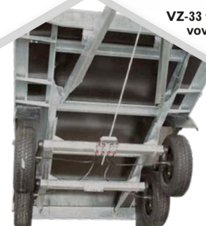
Masivní celosvařovaný rám podvozku
