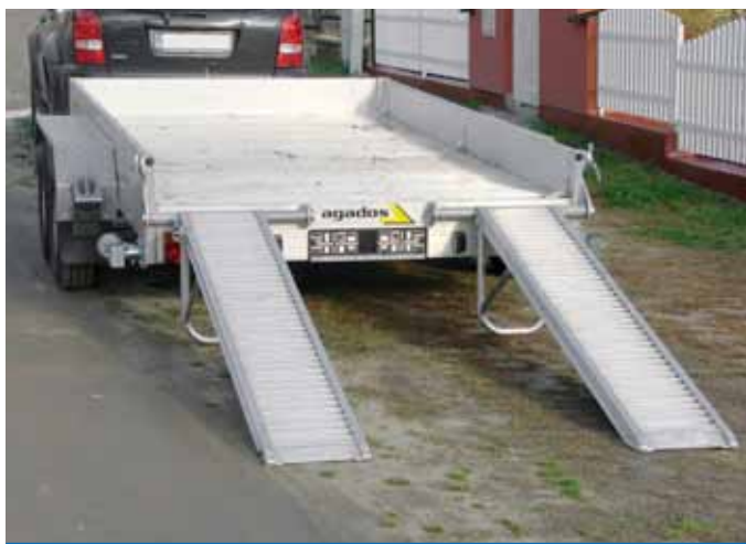
Hliníkový přepravník bagrů
