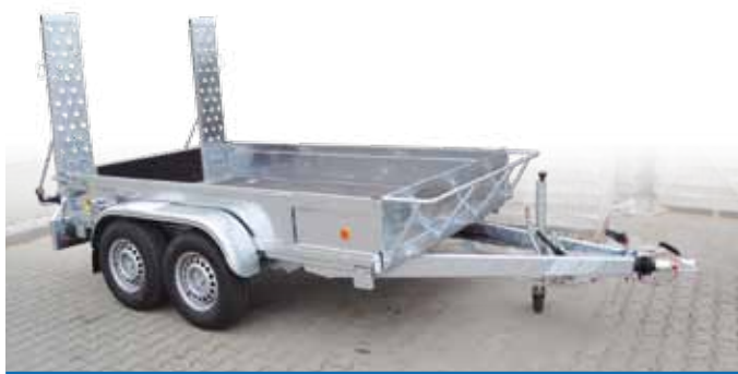
Zadní integrované železné nájezdy s vysokou nosností
