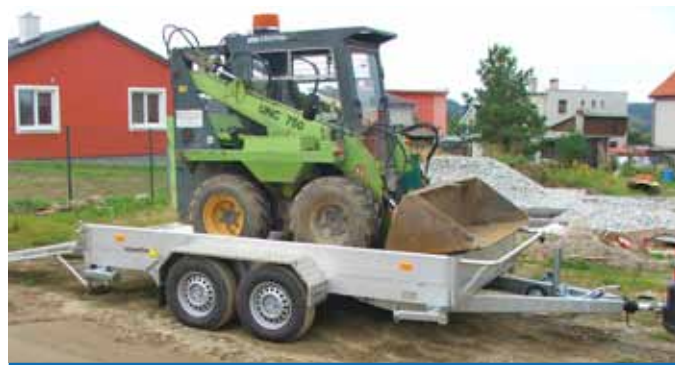
Hliníkový přepravník bagrů
