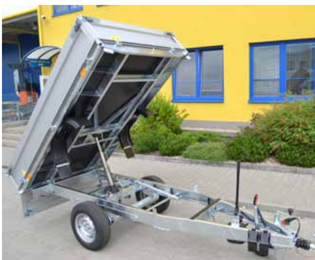
Přívěs Delta B1 s ručním ovládáním hydrauliky
