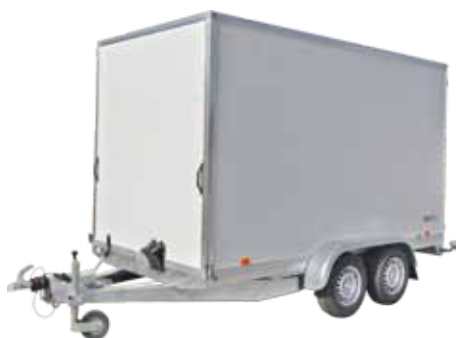
Sendvičová skříň s koly vedle ložné plochy
