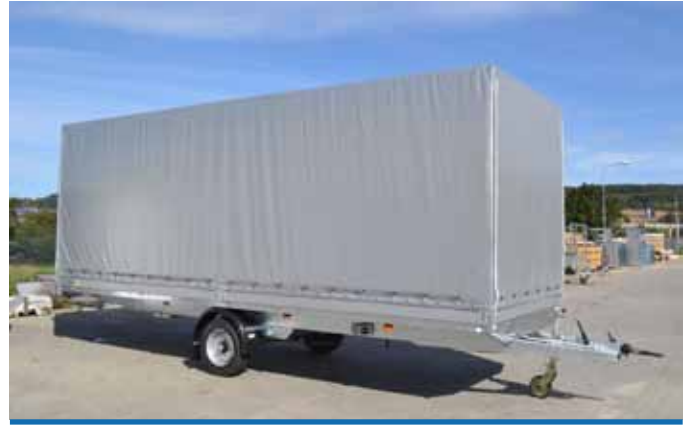
Jednonápravové provedení přívěsu DONA 3,5t pro nižší mýtné
