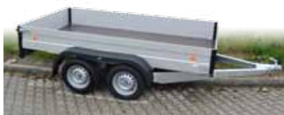
ALUX-31 N2 - dvounápravové nebrzděné provedení
