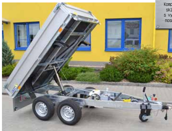
Přívěs Delta B2 s elektrickým ovládáním hydrauliky
