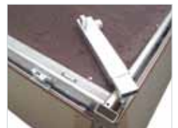
Kotvící třmeny v boční liště přívěsu
