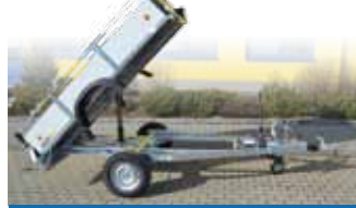
Přívěs VZ-26 B1 s hydraulicky sklopnou korbou
