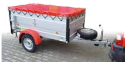
ALUX-3 N1 750 kg s nástavbou bočnic a překrývací plachtou
