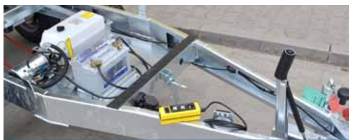
Elektrické ovládání hydrauliky s odnímatelným ovladačem
