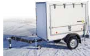
Přívěs VZ-21 s boční klapkou a výškově stavitelnou ojí
