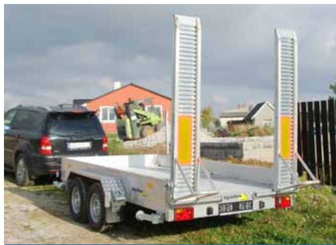
Zadní integrované hliníkové nájezdy
