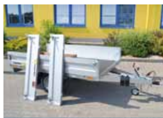
Odnímatelná čela a bočnice přívěsu
