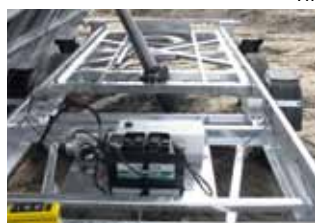
Elektrické ovládání hydrauliky
