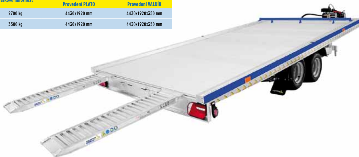
přívěs ADAM AL s posouvateľnými nájezdy po celé šířce ložné plochy
