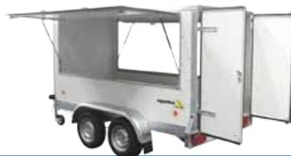
Přívěs VZ-31 s bočními klapkami a zadními dvoukřídlými dveřmi
