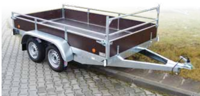
Přívěs VZ-31 N2 - nebrzděné dvounápravové provedení
