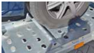
Posuvatelný doraz předního kola
