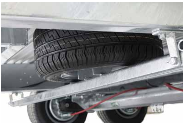
Rezervní kolo s držákem pod ložnou plochou
