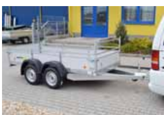
Nebrzděný dvounápravový přívěs VZ-30 N2
