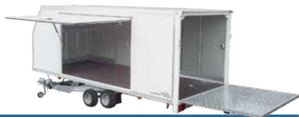
Přívěs ADAM s hliníkovou skříní v úpravě pro přepravu aut
