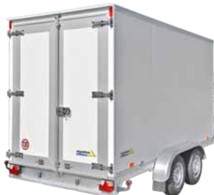
Zadní dvoukřídlé dveře v rámu s ALU profilu
