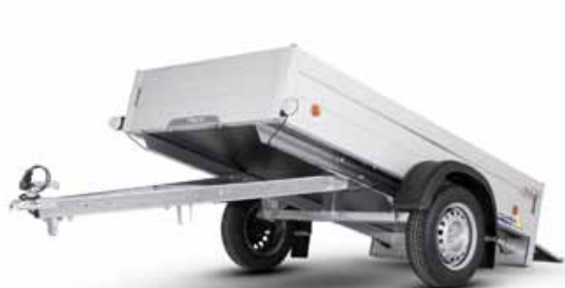
Přívěs Handy 8 ve sklopné variantě se zadním nájezdovým čelem
