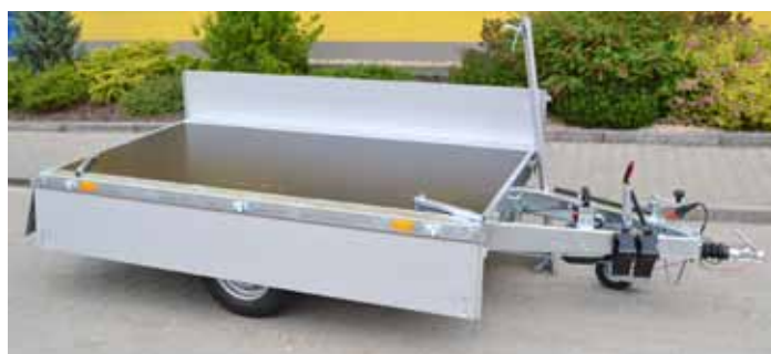
Snadné sklopení a odejmutí bočnic a sloupku
