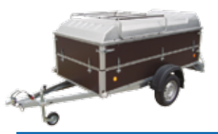
Přívěs VZ-26 s nástavbou bočnic a laminátovým víkem
