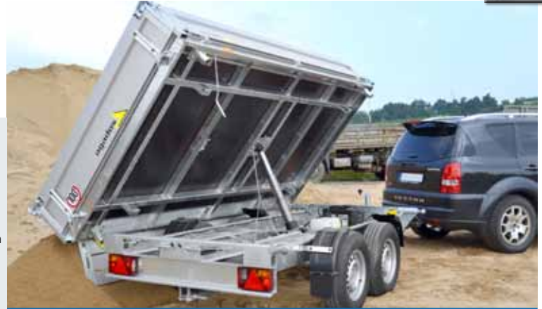
Celosvařený horní a spodní rám se silnou hydraulikou
