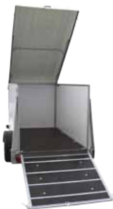
Zadní rampa s možností protiskluzové úpravy
