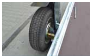
Hydraulicky sklopná náprava
