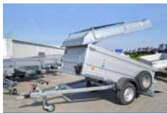
Sklopný brzděný přívěs VZ-26 s hliníkovými bočnicemi, s rezervou, nástavbou bočnic a laminátovým víkem
