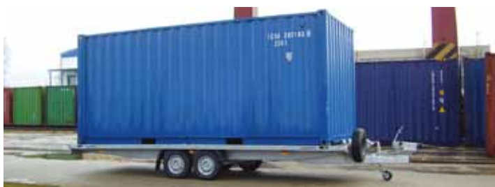
Privěs DONA v úpravě pro převoz prázdných ISO kontejnerů a buněk
